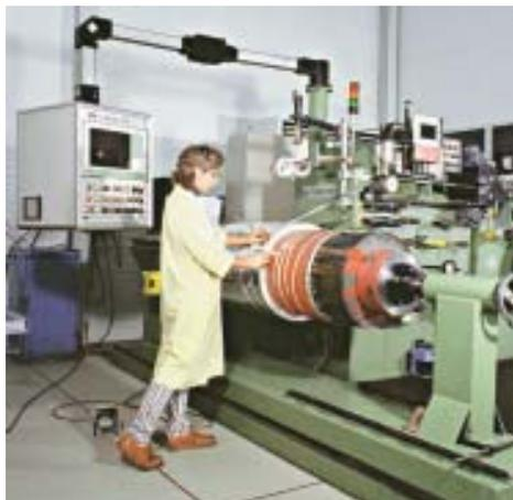
Torno para bobinas de MT en bandas.
