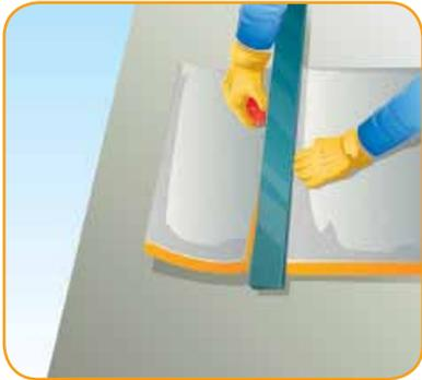
El material se puede cortar con un cuchillo para darle dimensiones exactas o formas irregulares. Todo tipo de suspensión mecánica visible a base de perfiles en forma de "Ts" y ángulos son sencillos de instalar.
