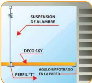
La moldura angular se coloca en la pared alrededor de la construcción, mientras que los perfiles en forma de "Ts" se cuelgan del techo mediante alambres. El resultado es una suspensión aparente sobre la que se colocan las placas de Deco Sky®.
