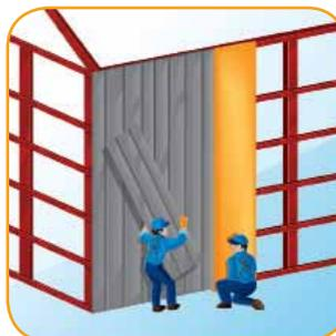
4- Colocar la lámina sobre el MBI y fijarla a la estructura.
