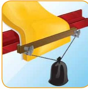
Fijar el extremo del MBI a lo largo de la estructura en techos y del alero en muros.
