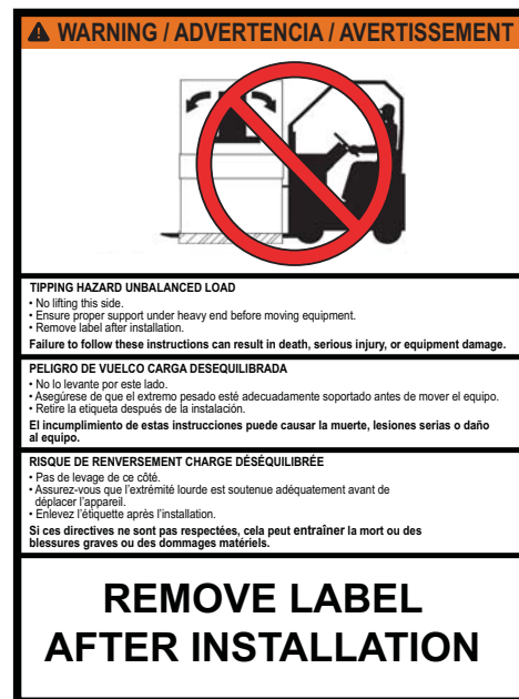
Figura 5 – Etiqueta de advertencia en la parte frontal – Tableros de distribución a prueba de lluvia
