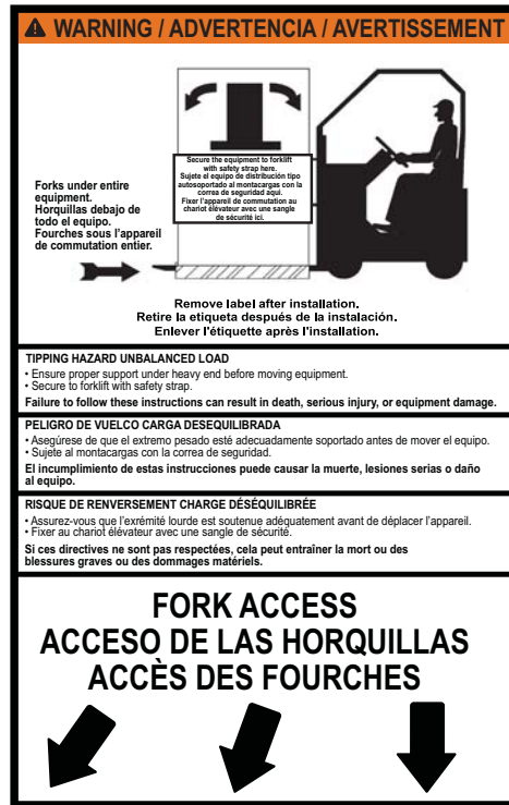
Figure 4 – Étiquette d'avertissement à l'arrière, panneaux de commutation à l'épreuve de la pluie
